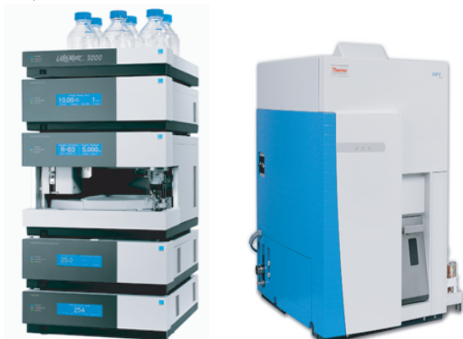
圖一、Thermo Scientific Dionex Ultimate-3000 串聯 Thermo iCAP-Q用於As, Cr, Se物種分析上的利器
