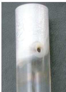
圖一、石英 Torch 因樣品分析含高濃度 Na、K、Ca、Li 而產生的 Devitirfication 現象
