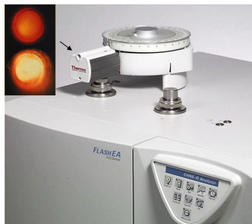
圖二、閃燃時將瞬間燃燒溫度提高至1800°C
